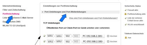
Damit ein Fernzugriff möglich ist, muss in in diesem Bereich für jede SPS eine Port-Umleitung eingetragen werden. Jede SPS erhält einen eigenen "Eingangsport" während der "Zielport" immer die 502 ist.
