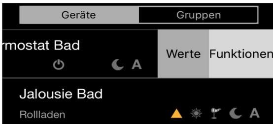
Wenn man auf „Thermostat Bad“ tippt, öffnet sich eine Steuerleiste. Durch antippen von „An“ bzw. „Aus“ kann zwischen dem Tagbetrieb (An) und dem Nachtbetrieb (Aus) gewechselt werden. Im Tagbetrieb ist das „ON-OFF-Symbol“ orange.
